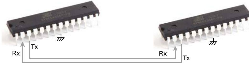
Dans le cas où tous les circuits et équipements fonctionnent avec les mêmes niveaux logiques, l'adaptation aux niveaux RS232 n'est plus nécessaire.
