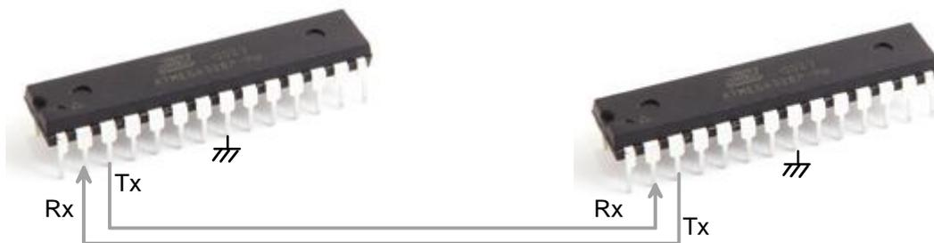
Dans cette mise en œuvre les documentations techniques indiquent liaison série 'serial level TTL'. Illustrons cette application avec l'étude de la documentation technique d'un transpondeur RFID fonctionnant sur la fréquence 125 kHz le UM-005 :
