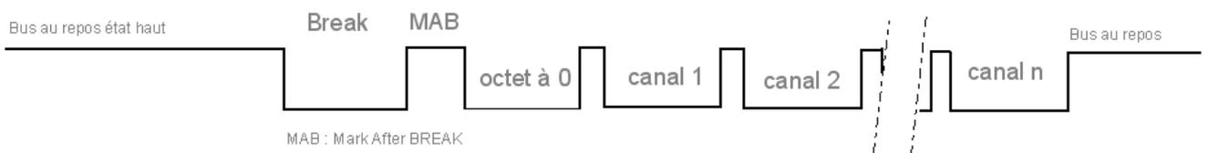
Après une attente au niveau haut la trame débute par une impulsion break niveau bas d'environ 220µs suivie d'une impulsion de Mark After Break d'environ 36µs puis d'un octet toujours nul. Les canaux sont ensuite envoyés depuis le n°1 jusqu'au numéro le plus élevé existant dans l'installation. A noter que chaque octet émis débute par un bit de start au niveau bas puis par les 8 bits de l'octet en commençant par le bit de poids faible.
