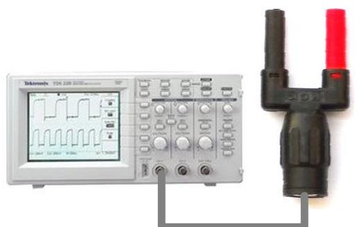
Notez que le cordon de mesure ne permet pas de connecter une liaison sur la broche n°2 qui a été neutralisée avec de la colle.
