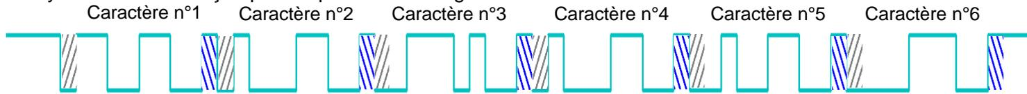
Les bits de start sont hachurés en gris et les bits de stop en bleu. Attention les data sont envoyées dans la trame bits de poids faible en tête.
